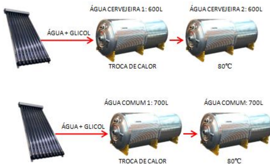
Figura 20 - Esquema de instalação dos reservatórios térmicos
