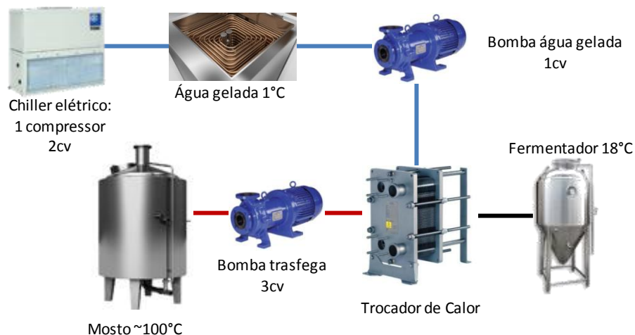
Figura 14 - Sistema de resfriamento do mosto
